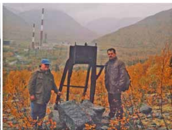
Сфеново-ловчорритовая обогатительная фабрика (слева) и динамометр Гоффа-Оттена для измерения силы удара лавины (справа). Sphene-lavchorrite dressing plant (left) and Hoff-Otten dynamometer to measure avalanche impact value (right).
