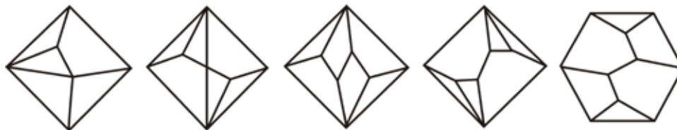
Рис. 3. Простейшие полиэдры с точечной группой симметрии 2. Ось симметрии хорошо видна на проекциях 2-5, поскольку перпендикулярна плоскости рисунка. На проекции 1 она занимает косое положение, проходя через середины рёбер, соединяющих пару 4- и пару 3-угольных граней.
