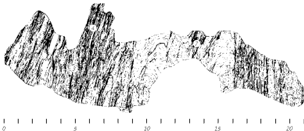
Рис. 52. Строение линзы железистых кварцитов Печегубского месторождения (см. рис. 3.25) от контакта с биотито-мусковитовыми гнейсами (0 м) к осевой зоне (21 м). Пронумерованные белые кружки – места отбора проб [Никитин, Иванюк, 1991].
