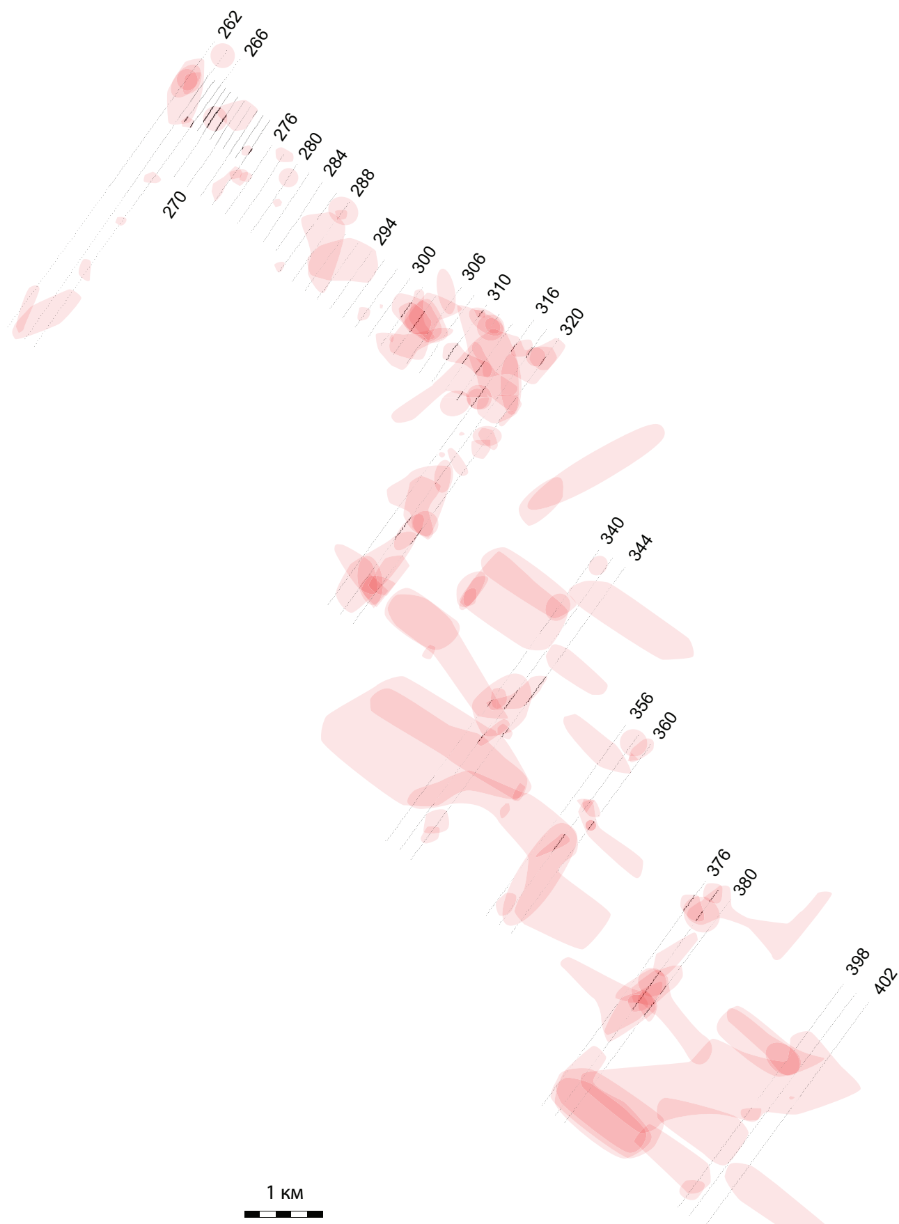
Рис. 86. Выделение перспективных площадей с помощью метода многомерных фазовых траекторий в пределах перспективного на платиноиды участка (Восточная Пана). Интенсивность красного цвета соответствует степени когерентности химического состава.
