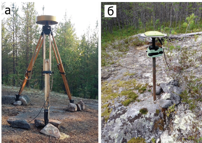
Рис. 2. Спутниковые антенны на пунктах геодинимической сети Кандалакшского залива: а) RingAnt G3T на штативе, б) MarAnt+ на металлическом резьбовом креплении
