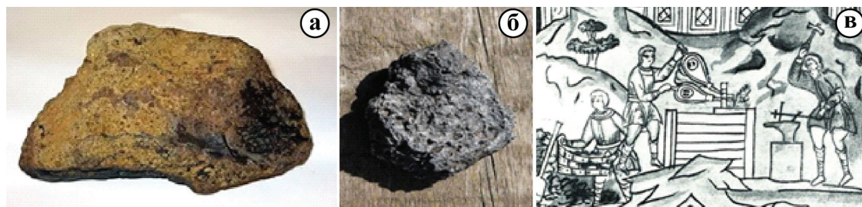
Рис. 6. а – Получение железа из болотных руд: болотная руда; б – крица; в – процесс получения железа из болотной руды, слева видна домница, где происходит плавка железа
